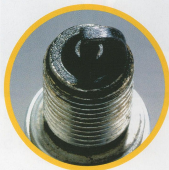
загрязнение неиспаренным топливом
